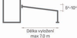
Verze kotvená do zdi
